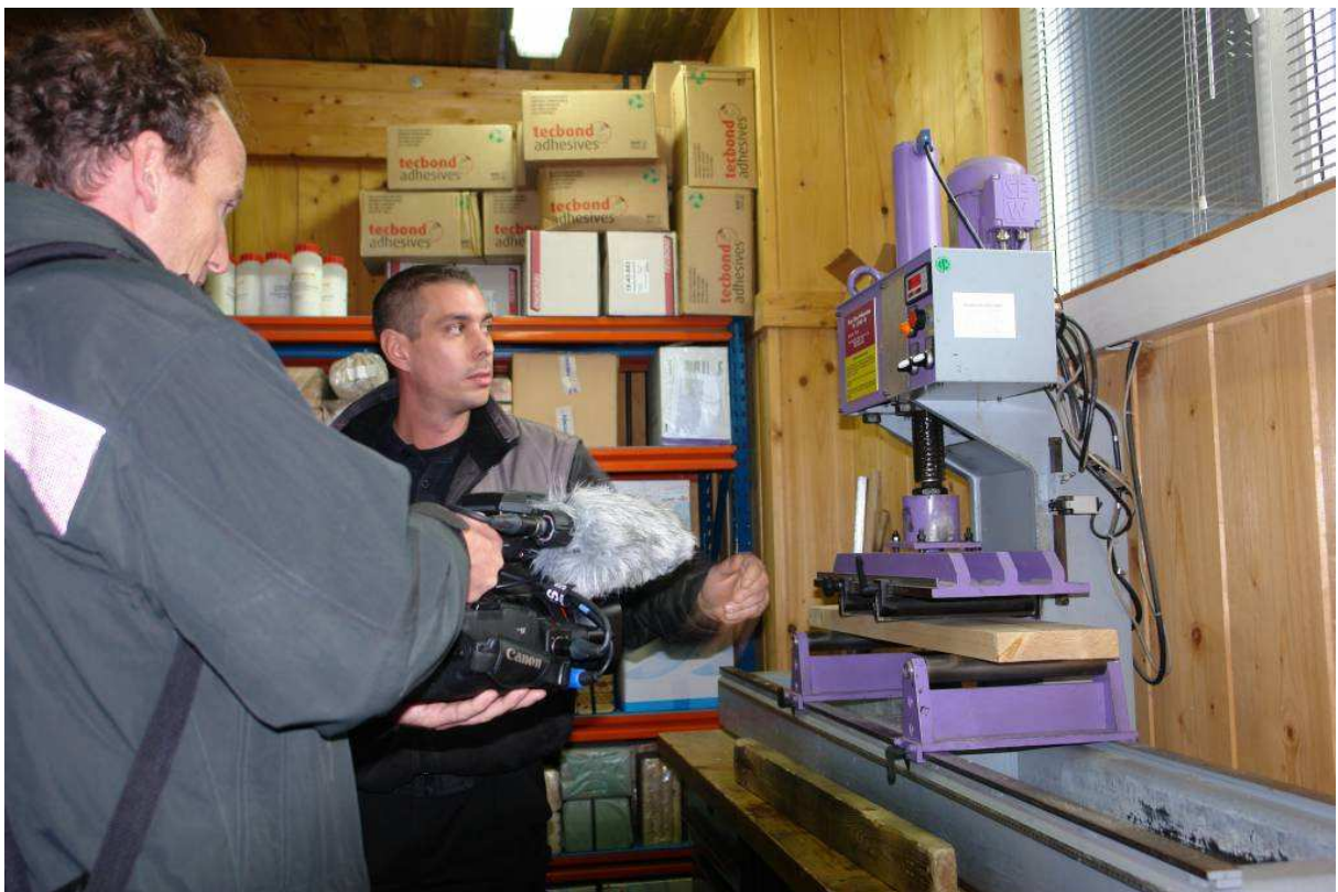
Regelmässige Qualitätskontrolle: Untersuchung des Bruchverhaltens
