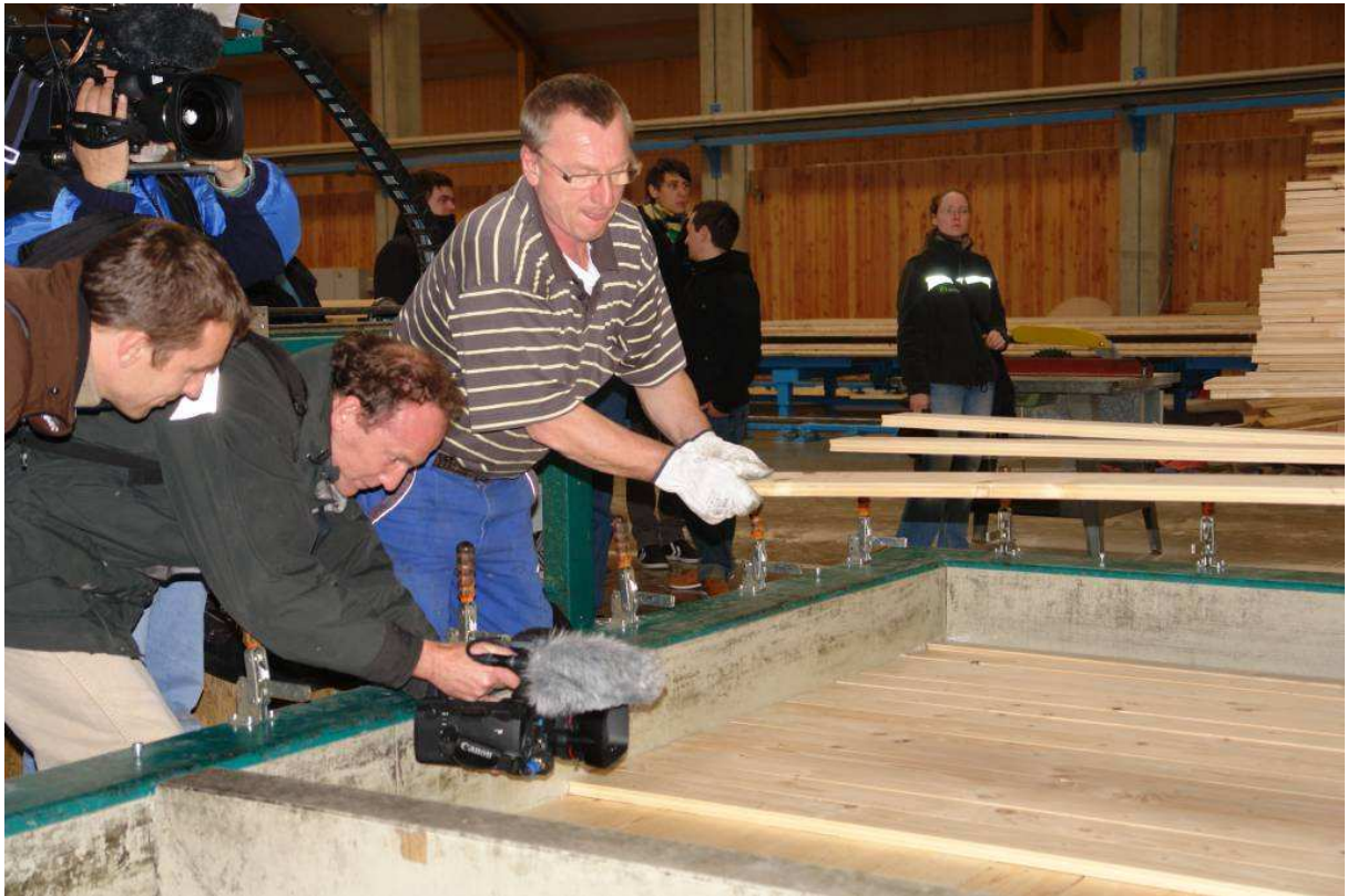
Fertigung der Brettsperrholzelemente
