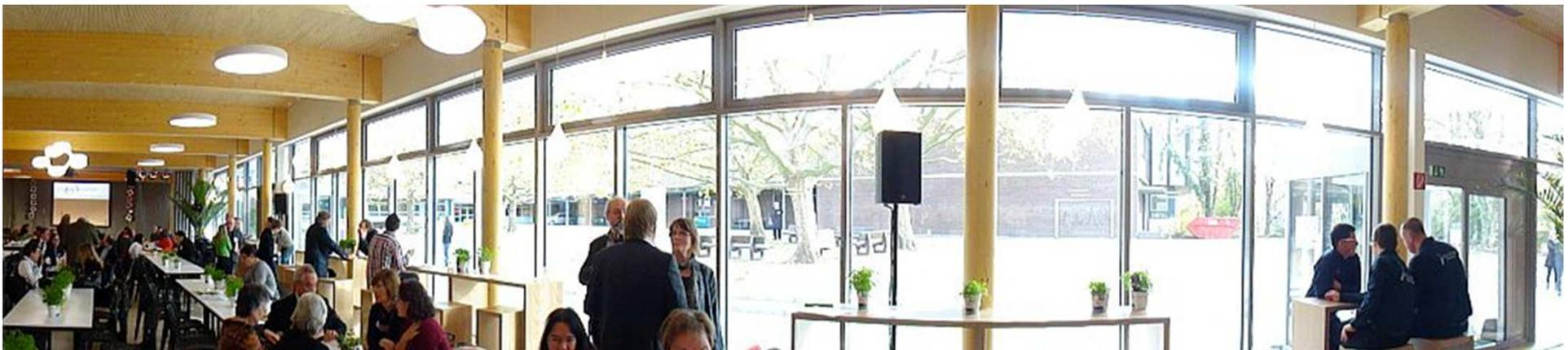
**Die neue Schulmensa des Gymnasiums am Römerkastell ist ein Holzgebäude in Passivhausstandard und wurde modular konzipiert, um die nötige Flexibilität für Folgeprojekten zu gewährleisten. Das vertikale Tragsystem des Speiseraums der Mensa besteht aus Rundholzstützen in heimischer Douglasie, der Holzfußboden aus Eiche. Im Vordergrund steht eine „Wohlfühlatmosphäre“ für die Schüler.**
