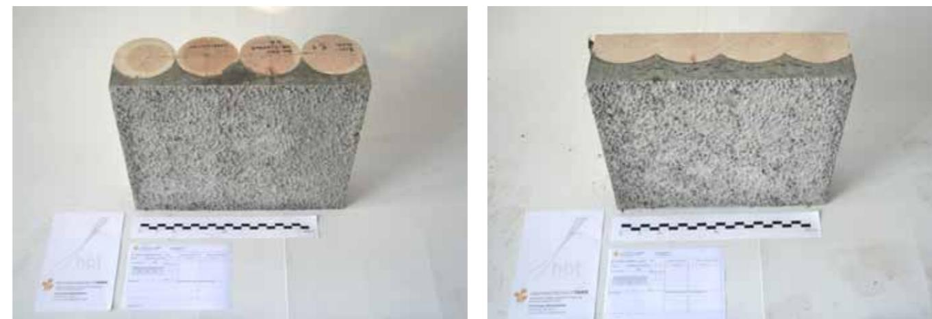
Abb. 20.7 FH Trier, Lehr- und Forschungsgebiet Holzbau, Prototypen Holz-Beton-Verbundelemente
