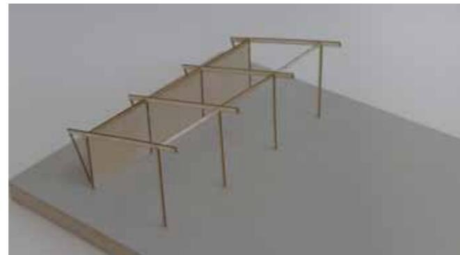
Grundmodul 6,00 x 5,00 m mit aussteifender Wand. Dient als nutzbare Fläche, z.B. für Schüttgüter. Ebenso läßt sich die Konstruktion als Stabkonstruktion mit Diagonalverbänden ohne tragende oder aussteifende Wand herstellen.
