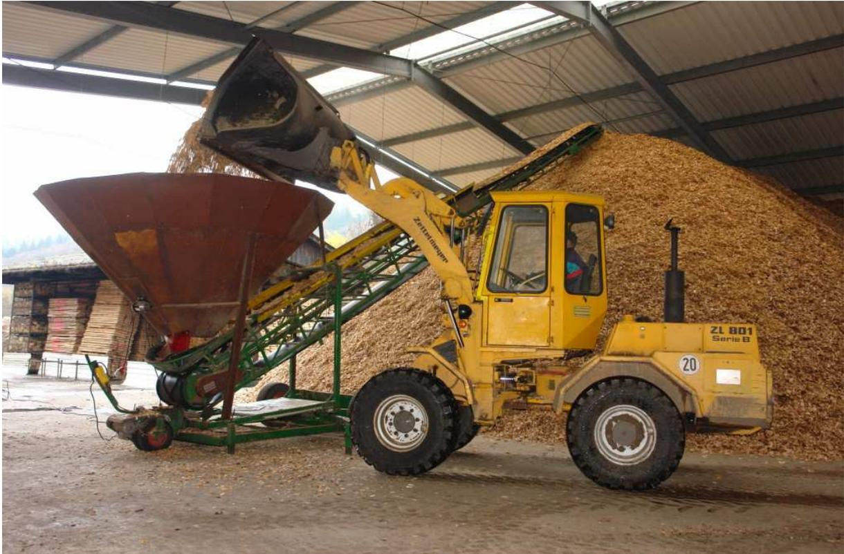
Qualitätsmanagement: Nach dem Hacken und Sieben werden die Laubholz-Hackschnitzel unter Dach luftig gelagert und auf Sollfeuchte herunter getrocknet.
