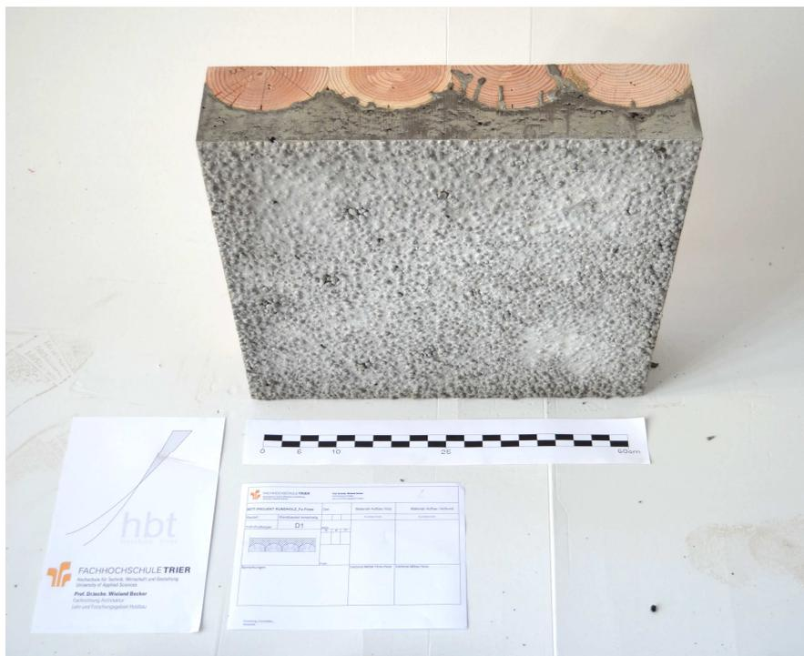
An der FH Trier entwickelte Prototypen Holz-Beton-Verbundelemente, \_Forstbetriebshöfe, Handbuch Planung und Konstruktion, FH Trier
